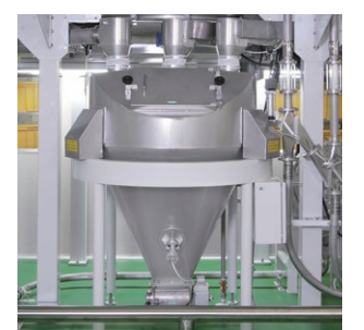
パウスケール・ホッパー型 シンプルで無駄のないデザインのホッパー型計量機
