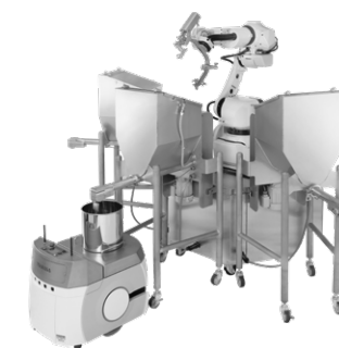
パウスケール・モバイルロボット 計量機能付きAMRを活用して、計量→搬送を自動化
