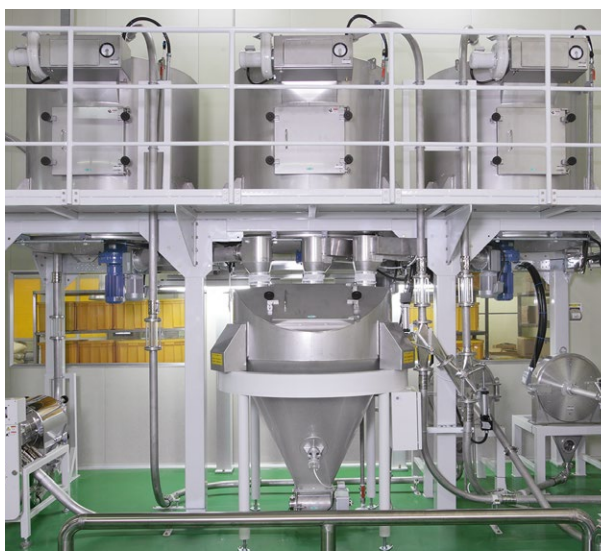
3.粉碎・貯槽・計量及びふるい設備
