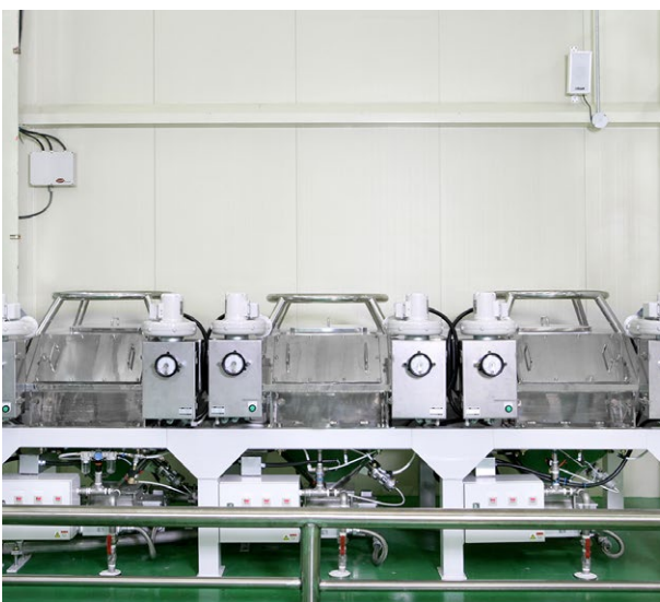
2.フレコン受入及び原料輸送設備
