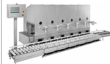
ディバイダースケール・コンビネーション 自動で多品種の計量を行うことができる自動小分け計量機
