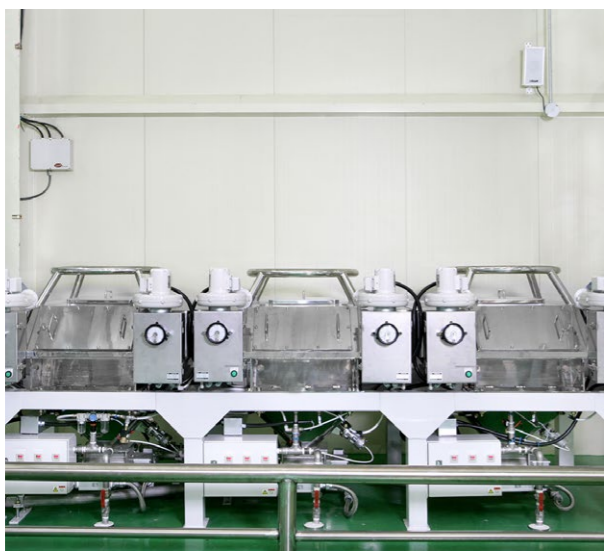
2.フレコン受入及び原料輸送設備
